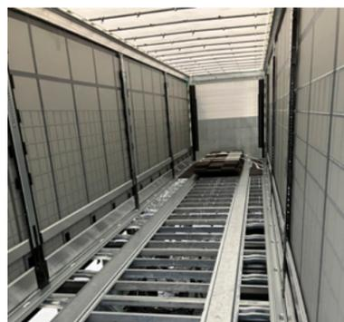
**Châssis MODULOS roulé :** Traverses pleine largeur au pas de 400 mm. Pour une capacité de charge ponctuelle élevée.
