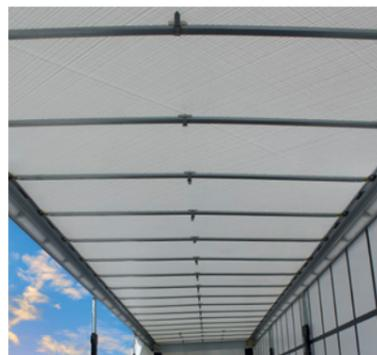
**Toit de sécurité Schmitz Cargobull** Le raidisseur diagonal intégré augmente la résistance de la superstructure.
