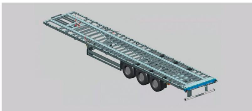
Longerons soudés pleine longueur pour une résistance à la déformation et une capacité de surcharge élevée.
