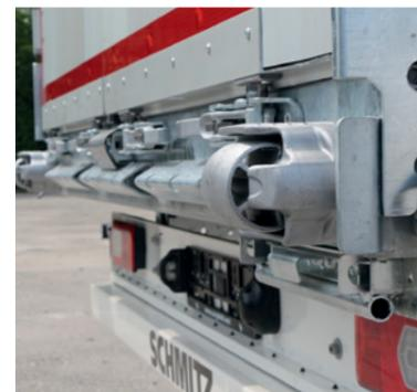
**Pack HD Hard Docking** - Mise à quai usage sévère: Cadre arrière renforcé avec barre Delta, butoirs à rouleau et jambes de force dans les angles.
