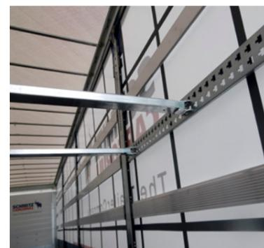
**Sécurisation du chargement :** de nombreuses possibilités, par exemple avec un système flexible de sécurisation du chargement.
