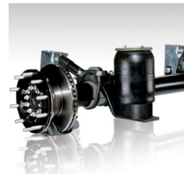
**Essieux ROTOS** avec disques de freins ventilés diamètre 430mm. Garantie de 6 ans ou 1 million de kilomètres.
