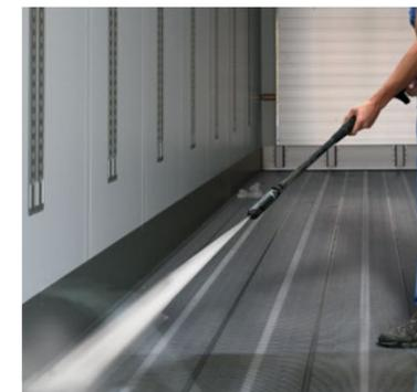
**Plancher aluminium anti dérapant de série:**
