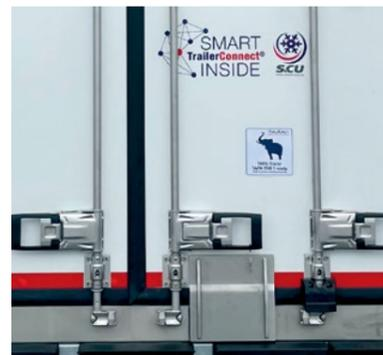
**Système de fermeture de porte sécurisé TL4\*** pour une protection fiable des marchandises. Limite toute tentative d'intrusion
