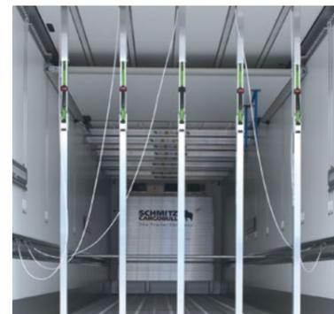
**Poutre d'arrimage verticales\*** Simple et rapide à mettre en oeuvre, les poutres trouvent leurs inserts de callage sur le plancher et sur les rails de toit.
