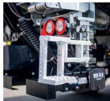
**Neue Klappbare Leiterkonstruktion**, die mit SafeStart gekoppelt ist: Wenn die Leiter ausgeklappt wird, wird gleichzeitig die Bremse aktiviert. Mit zwei Stufen auf beiden Seiten bietet sie bequem einen sicheren Zugang zum Fahrzeug.
