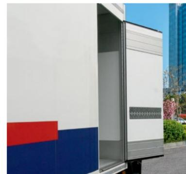
**Seitentür** ermöglicht Teilentladung und separaten Zugang zu einzelnen MultiTemp-Kühlzonen.
