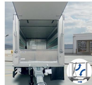
**Übergang im Durchladezug:** Stirnwandklappe für Anhänger Z.KO wird als Wetterschutz hochgeklappt und Abstand mit pneumatisch verriegelter, ausziehbarer Zugstange angepasst.\*
