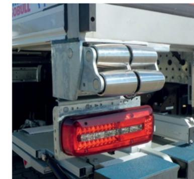
**Dynamic Ramp Protection (DRP)** und ein doppelter Gummistreifen schützen das Heck beim Anfahren an die Rampe.
