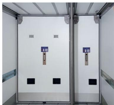
**Verschiebbare Trennwand** aus stark isolierendem FERROPLAST®: Schnelle, variable MultiTemp-Aufteilung; wahlweise für 1/3- und 2/3-Teilung oder als durchgehende Wand lieferbar.
