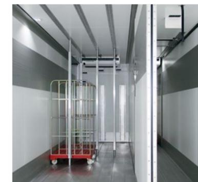
**Airline-Schienen** in Decke und Boden vereinfachen die Ladungssicherung mit senkrechten Teleskopbalken.
