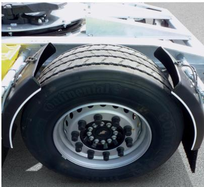
**Kunststoff-Einzelrad-Kotflügel** in dreiteiliger Ausführung. Zur Anpassung an Aufsattelhöhen von 1.050 bis 1.100 mm kann das Mittelteil herausgenommen werden.
