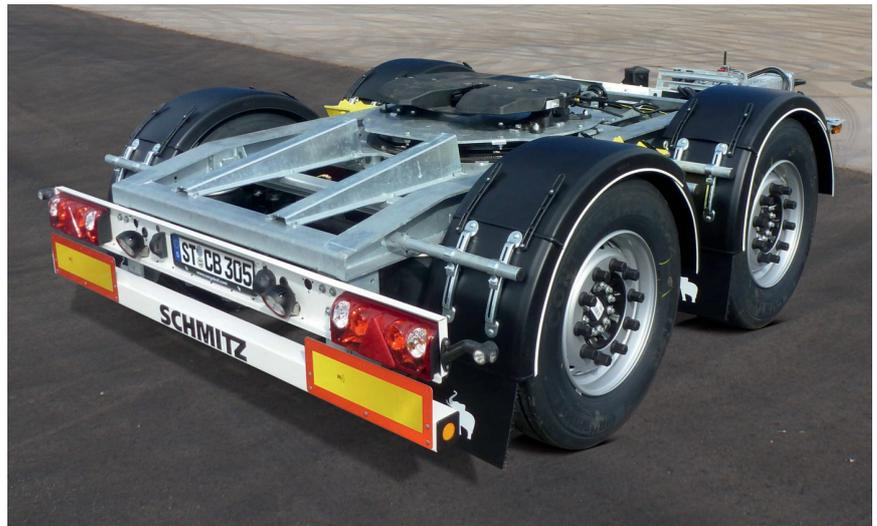
**Bewährte Technologie von Schmitz Cargobull in modularer Bauweise:** Verzinktes Chassis und ROTOS-Achse mit verschleißbarem Bremssystem und hochwertiger Ausstattung.
