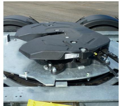
**Drehbare Sattelkupplung** dient als Verbindungselement zwischen Motorwagen und Sattelauflieger.
