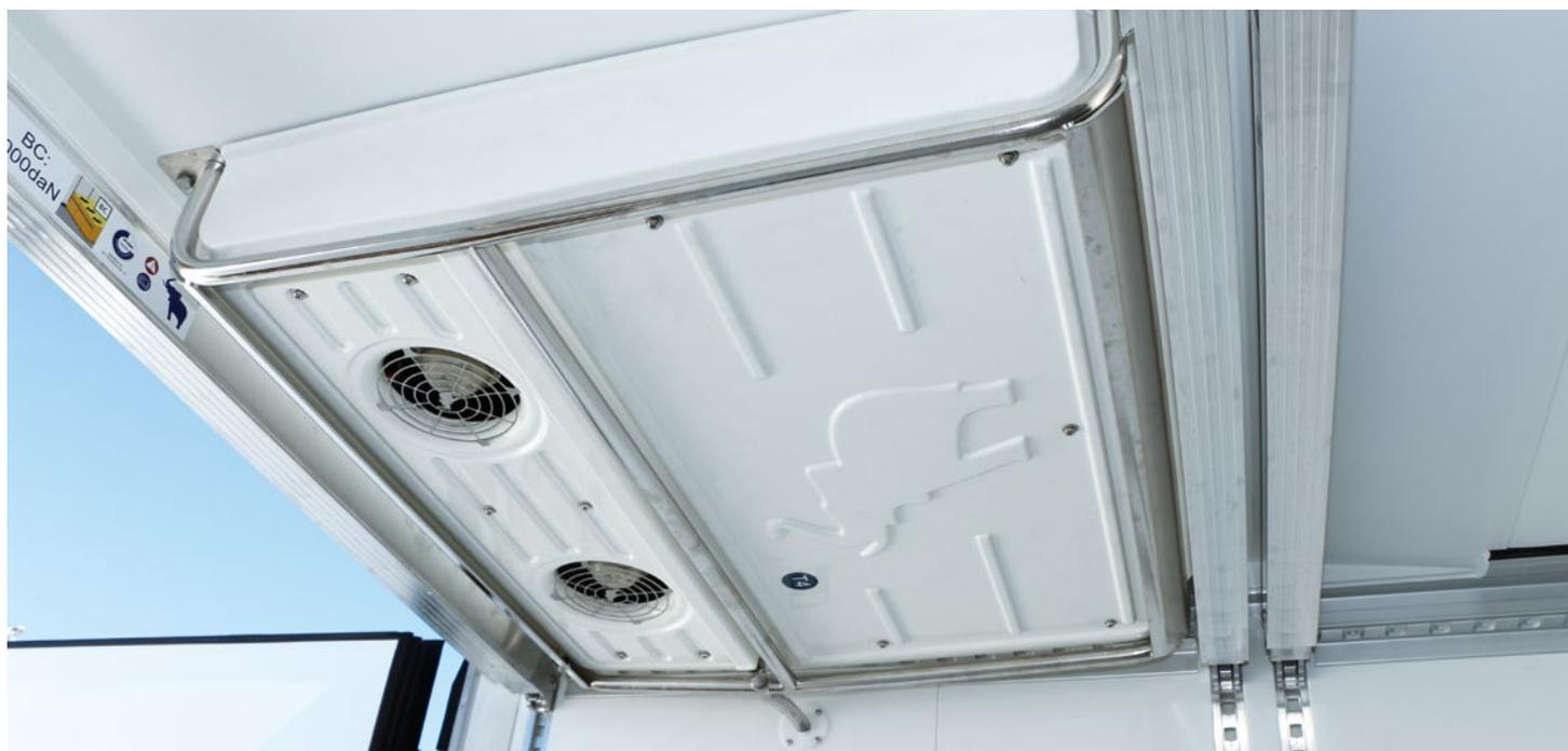
Powerpack unter der Decke: Die leistungsfähige Technik des Schmitz Cargobull Deckenzusatzverdampfers sorgt für eine gleichmäßige Temperaturverteilung. Der Wärmeübertrager mit großer Verdampferoberfläche punktet mit hoher Leistung und wenig Abtauzyklen aufgrund geringer Vereisung.
