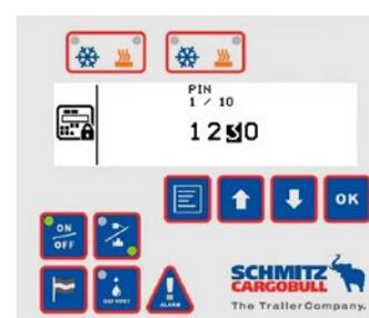
Gegen den unbefugten Zugriff auf die Kältemaschine ist das Bedienpanel mit einem vierstelligen PIN gesichert, den Sie individuell ändern können.
