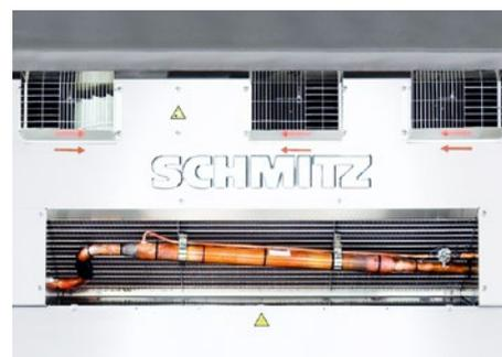
Drei Lüfter am Verdampfer für optimale Luftverteilung im Aufbau.
