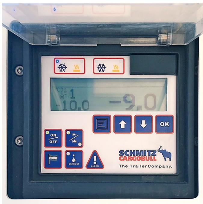
Das Kontrollpanel am Kühlgerät ermöglicht die Konfiguration aller für den Transport wichtigen Stellgrößen. Hier z.B. exakte Temperaturangabe und eingestellte Setpoints.
