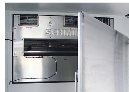
Der Ansaugkanal für den Verdampfer liegt gut geschützt hinter der Zirkulationswand.
