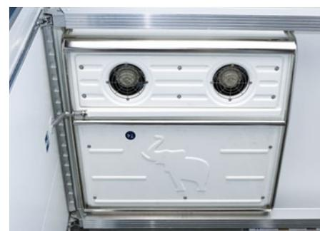
Die extrem flache und kompakte Bauform des Schmitz Cargobull Deckenzusatzverdampfers bietet mehr Ladehöhe unter dem Gerät. Das robuste Gehäuse mit integriertem Schutzrahmen verhindert Beschädigungen des Verdampfers.
