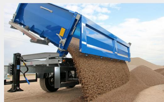
Dank neuer Konstruktion 60 Kilogramm leichter: der Z.KI mit Zentralachse.
