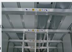
Das Luftverteilungssystem im S.KO COOL SMART macht den flexiblen Einsatz von Ladungssicherungsstangen möglich.
