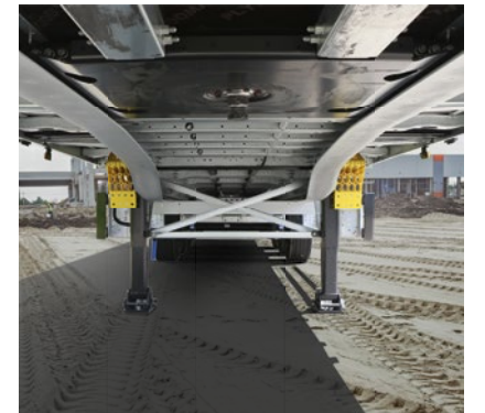
Sıcak daldırma galvanizli, cıvata-somunlu bağlantılardan oluşan onarım dostu MODULOS şasi .
