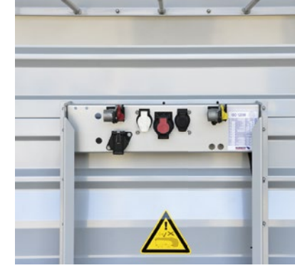
Elektrik ve basınçlı hava için bağlantı klemensi , optimum yükseklikte monte edilir ve kolayca erişilebilir.
