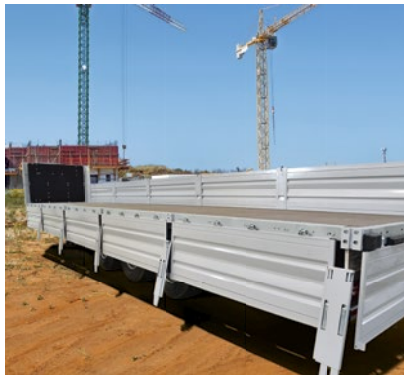
Çıkarılabilir yan kapaklar ve geçmeli dikmeler , platform tip treylere kolay dönüşüm sağlar.
