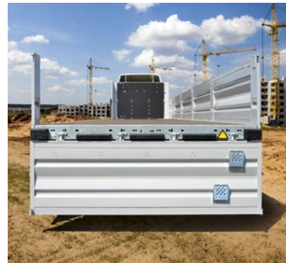
800 mm yüksekliğinde yan kapaklar ve arka kapak .
