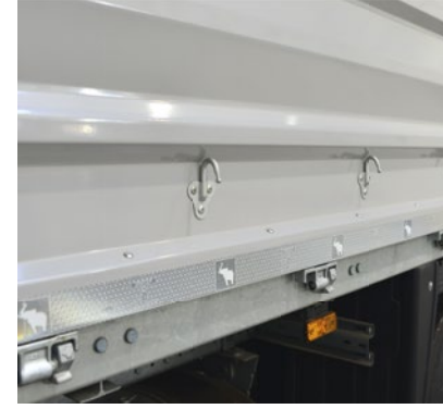
Yük brandasının kolay takılması için yan kapaklarda ve arka kapakta bulunan branda kancaları .
