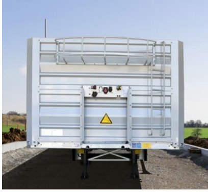
1.600 mm yüksekliğinde çelik sepet ve merdiven ile donatılmış çelik ön duvar
