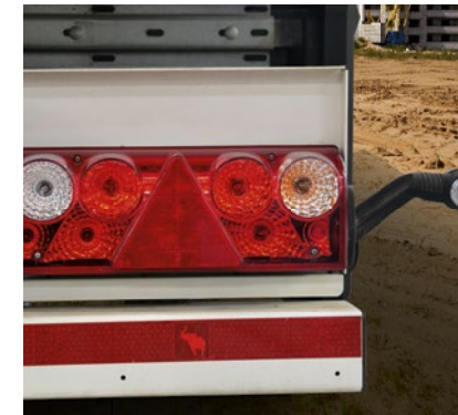
Çok bölmeli arka lamba sayesinde camın simetrik yedek cam ile değiştirilmesi çok kolaydır.
